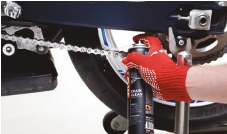
› MOTUL Kettenspray immer auf die Innenseite sprühen
