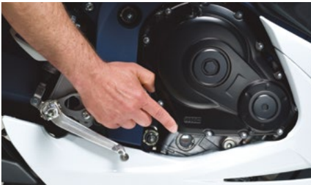
> Ölstand am Schauglas überprüfen
